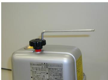
六角棒スパナで操作する場合は、ゆっくり操作してください。アクチュエータにはストッパーが内蔵されておりストッパーが当たった位置でハンドル操作が重くなります。この状態で無理にハンドルを回転しないで下さい。無理に回転させますとアクチュエータ内部部品を保護するためにハンドルに設けた安全機構がはたらき、ハンドルが空回りするようになります。一度安全機構が作用したハンドルは使用できません。ハンドルの交換が必要になります。
