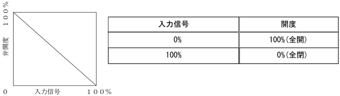
図 11 正作動（入力信号と弁開度）
