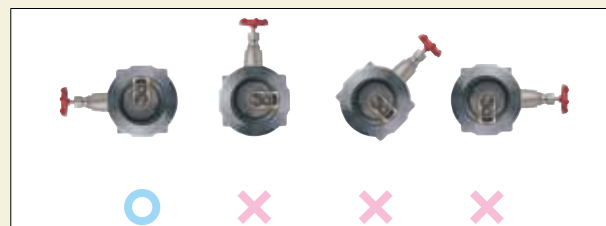
図③水平配管でのバルブ取付姿勢(シングルプレート形)
