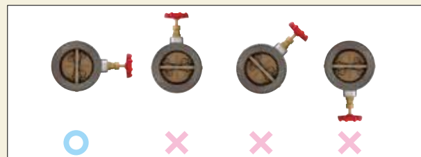
図③水平配管でのバルブ取付姿勢(シングルプレート形)
