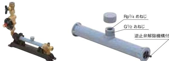
●検査代用管を使用して耐圧検査を行う場合は、減圧弁のキャップをテストガグに交換し、止水栓を閉じてください。(詳細は、取扱説明書をご確認ください。) 逆止弁解除機構付の場合は、容易に屋内配管の水圧検査も行えます。(WMU-TTN(N)20)
